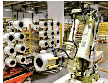
在泰山玻璃纤维有限公司，工业机器人搬运玻璃纤维产品。
