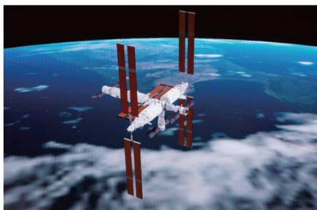
神舟十九号载人飞船和空间站天和核心舱前向端口对接过程的模拟画面。
