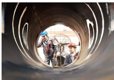
山东博宇重工科技集团有限公司的质检人员在测量压力容器尺寸。
