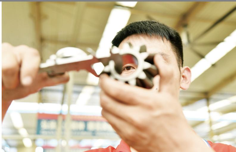
山东润通齿轮集团有限公司的工人在对齿轮进行测量。
