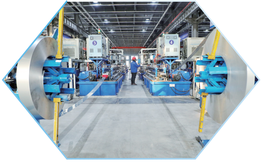
山东奥士康新材料科技有限公司数控智能化满壁不锈钢焊管生产线。
