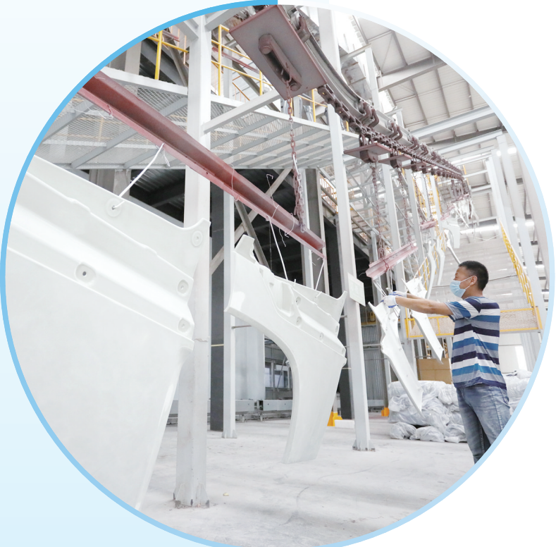
新泰市鲁中环保产业园汽车配件智能共享喷涂。
