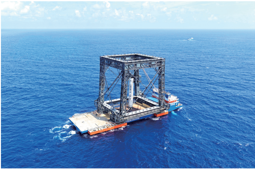
■这是海上回收平台通过网系捕获方式成功回收长征十号乙运载火箭一级级(7月10日摄，无人机照片)。
