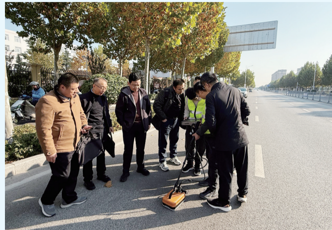
市审计局运用探地雷达技术对全路段进行扫描。 通讯员供图
