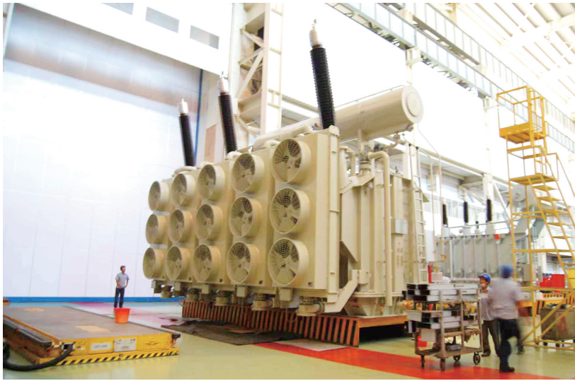
■山东鲁能泰山电力设备有限公司的强迫油循环220千伏电力变压器。 通讯员供图
