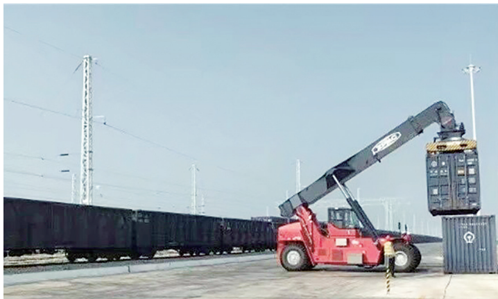
■集装箱正面起重机将集装箱吊起。
