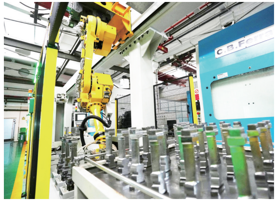
在哈尔滨汽轮机厂有限责任公司叶片分厂,中小叶片智能生产线上的机械臂在安装卡紧汽轮机叶片。 新华社发
