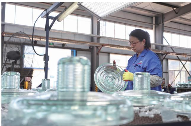
在山东瑞泰玻璃绝缘子有限公司生产基地，一块块钢化玻璃绝缘子在自动化生产线上缓缓移动，经过精细打磨和严格检测，被用于高压、超高压、特高压输电线路等重要领域。企业凭借其先进的生产设备和技术实力，通过自动化、智能化技术的应用，生产效率大幅提升。
