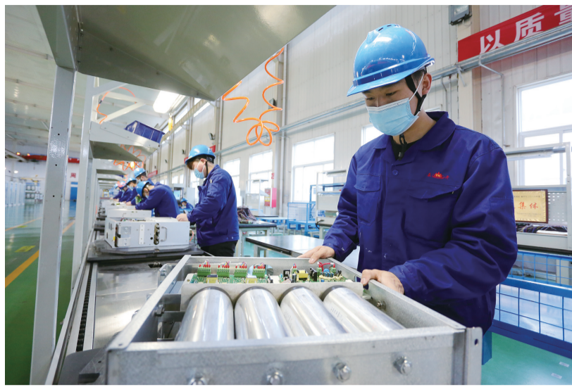
■山东泰开电力电子有限公司电力电子车间内,工人们正在生产SVG动态无功补偿装置、SVC动态无功补偿装置。
