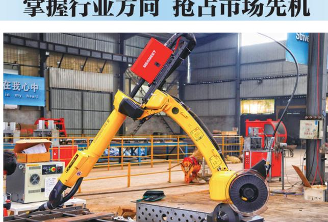
■龙辉起重机械自动焊接机器人。 通讯员供图
