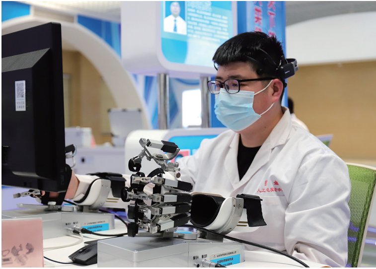
山东海天智能工程有限公司工程师调试康复机器人。
